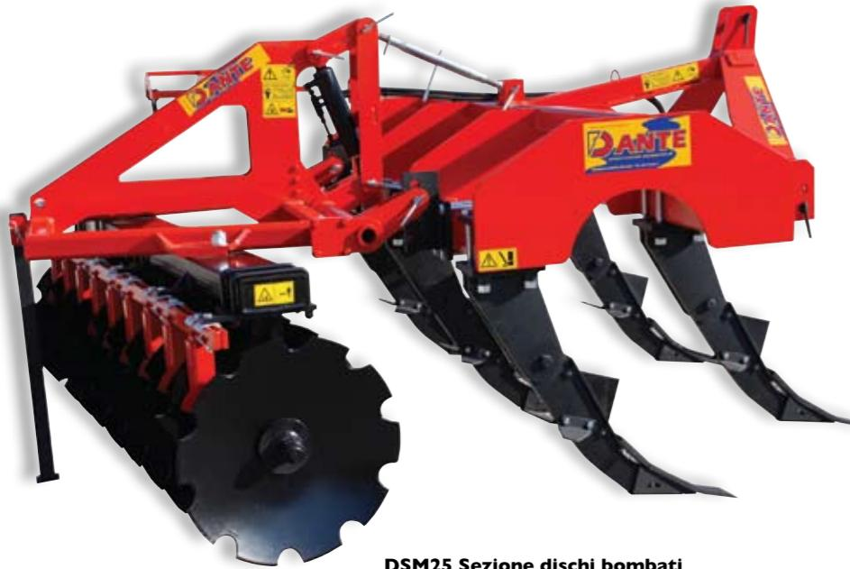
**DSM25 Sezione dischi bombati**
